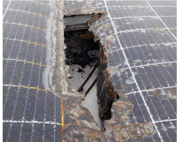
Bild 1: Schaden nach einem im PV-Modul generierten Lichtbogen (Quelle: VGH)
